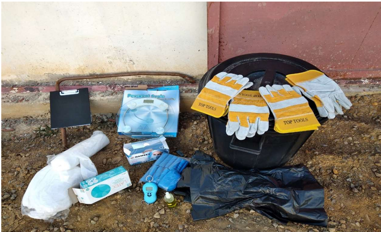
Figure 10 : Exemple de matériels de base pour une opération de caractérisation des déchets
