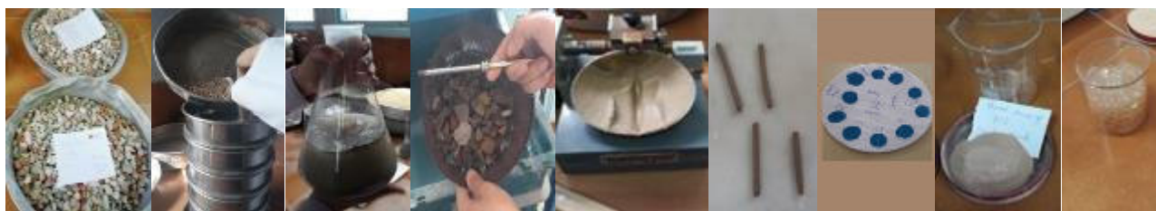
Figure 14 : Essais d'analyse granulométrique, de masses volumiques, d'absorption d'eau, de limites d'Atterberg, de présence de fines argileuses et d'analyses chimiques (% Matière Organiques, SiO 2 , SO 3 , CaCO 3 et CaO)
