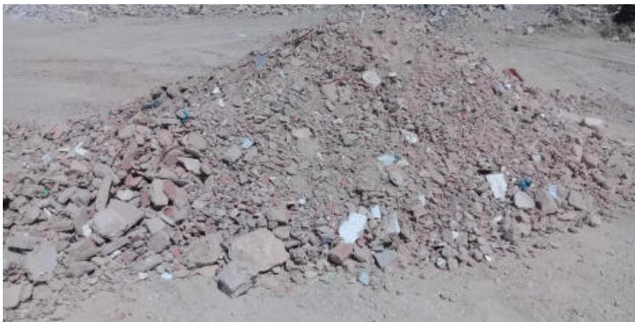
Figure 29 : Obtention d'environ 90% de déchets inertes à la suite d'un tri manuel des déchets de chantiers bruts
