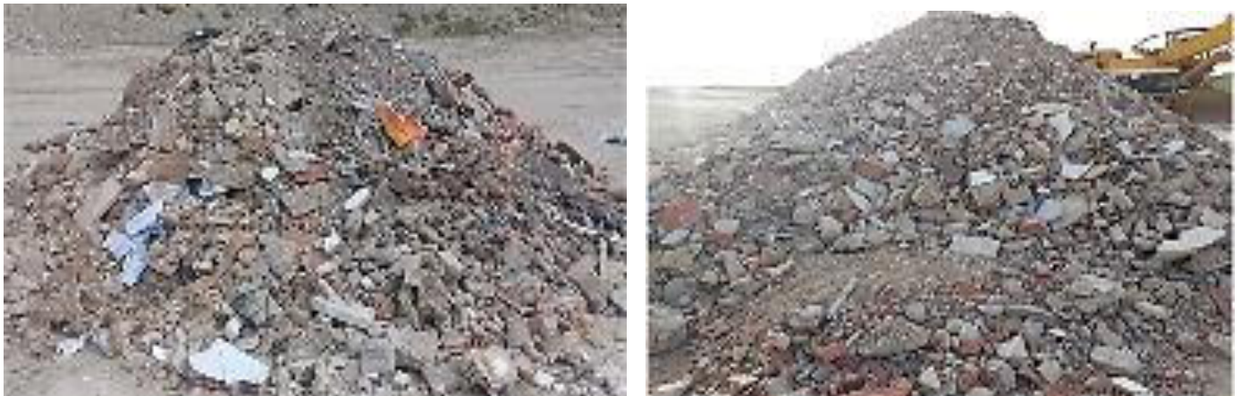
Figure 11 : Obtention de 80% de déchets inertes (photo de gauche) à la suite d'un tri manuel des déchets bruts (photo de droite)
