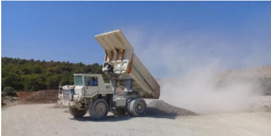
Figure 32: Transport du matériau alternatif recyclé obtenu après concassage
