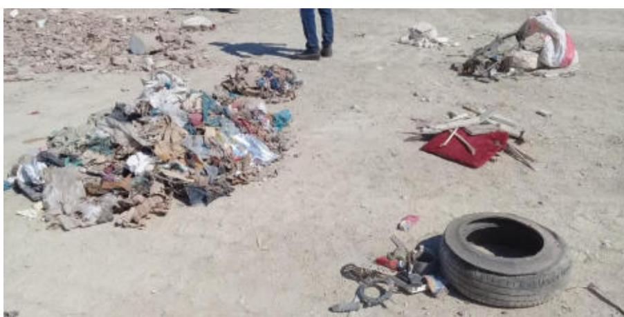
Figure 26: Déchets divers (ménagers, métalliques, organiques, plastiques, cartons, emballages, verres, bois, plâtre, etc.) éliminés des déchets de chantiers bruts
