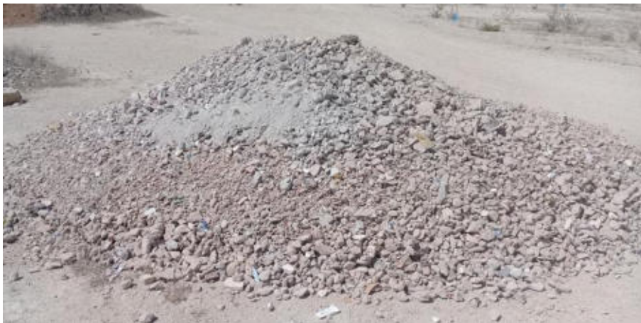
Figure 33: Matériau alternatif recyclé obtenu : Granulats « Tout-venant » 5 / 70 mm
